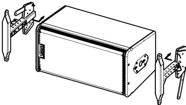
Verrouiller la broche à bille de sécurité sur la plaque de connexion.
