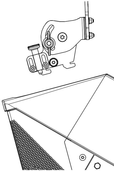
Inclinaison positive : plot de verrouillage vers l'arrière.
