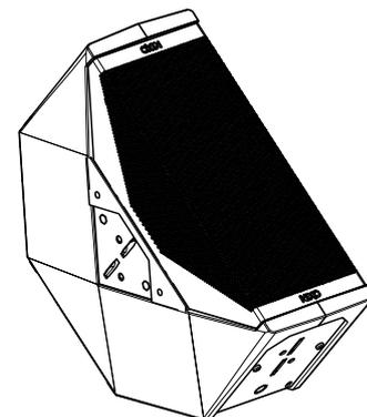
Insérer QRA et pousser jusqu'au verrouillage automatique.
