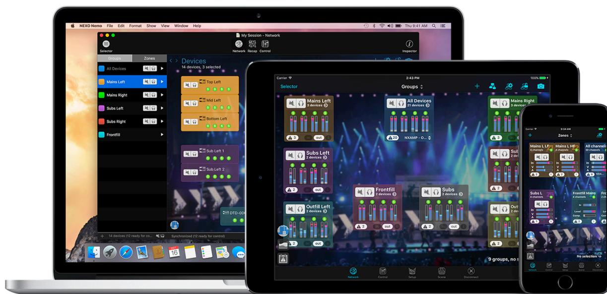
La gestion et le positionnement des amplificateurs, la vérification de leurs paramètres (niveaux, etc.) et la configuration de nouvelles valeurs (preset, volume, délai, EQ, etc.) sont rendus possibles grâce à une interface utilisateur esthétique et intuitive. NEXO NeMo intègre en outre un puissant moteur de journalisation, d'alerte et d'envoi d'e-mails.
