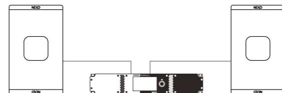
Système actif stéréo, 1 x 1 x P18 (Actif) par côté, alimentation par 1 x NXAMP4X4MK2
