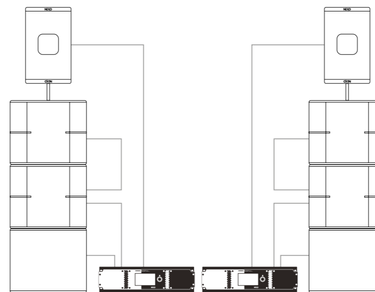
Système de façade moyen : (par côté) 1 x P18 (active) posée sur 2 x caissons L20 et 1 x caisson L20 Sub (mode cardioïde, alimentation par 2 x NXAMP4X4MK2
