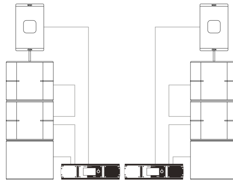
Système de façade moyen : (par côté) 1 x P15 (active) posée sur 2 x caissons L18 et 1 x caisson L18 Sub (mode cardioïde), alimentation par 2 x NXAMP4X4MK2
