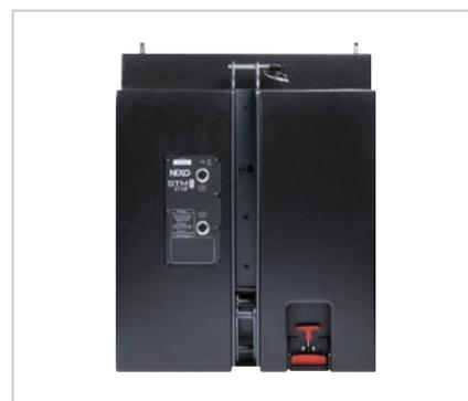
Le dispositif d'accroche utilise deux technologies innovantes, PistonRig™ et REDLock™, permettant à une seule personne de suspendre un système de n'importe quelle taille. Le PistonRig™ permet de pré régler les valeurs des angles entre enceintes. La poignée REDLock™ sert à verrouiller les points d'accroche à l'avant depuis l'arrière du coffret. Tous les réglages s'effectuent depuis un emplacement, à l'arrière du cluster.
