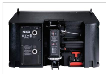
Le dispositif d'accroche utilise deux technologies innovantes, PistonRig™ et REDLock™, permettant à une seule personne de suspendre un système de n'importe quelle taille. Le PistonRig™ permet de pré régler les valeurs des angles entre enceintes. La poignée REDLock™ sert à verrouiller les points d'accroche à l'avant depuis l'arrière du coffret. Tous les réglages s'effectuent depuis un emplacement, à l'arrière du cluster.
