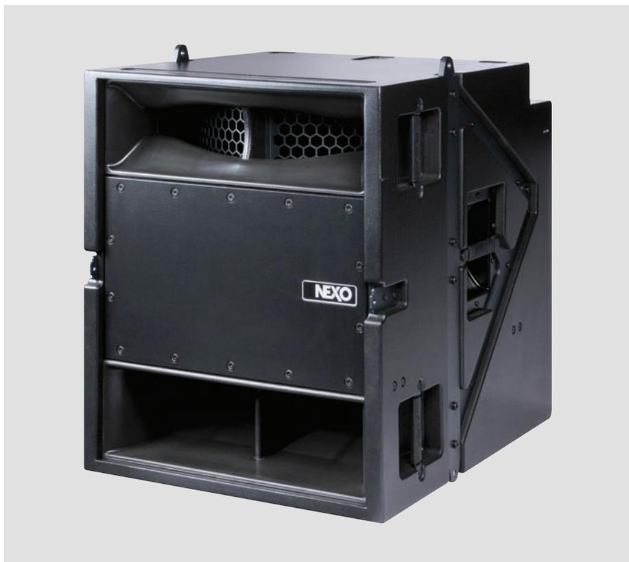
Enceinte sub-bass à coffret moulé par injection, équipée d'un boomer de 18 pouces (46 cm) de grand débattement à aimant néodyme, puissance admissible 3000 W. Sa charge de type passe-bande assure un niveau de sortie SPL équivalent à celui de caissons équipés de deux boomers de 18 pouces. Elle possède la même largeur que le module principal M46, mais une hauteur double, ce qui permet de l'intégrer dans le même array suspendu ou le stack posé au sol.
