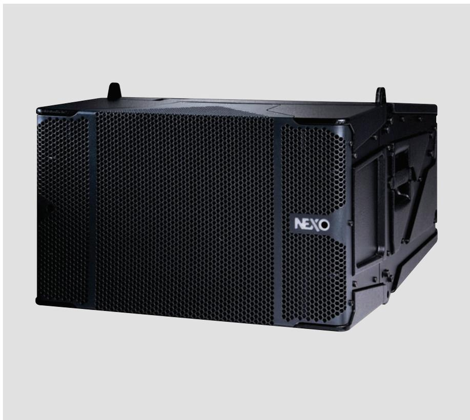
Enceinte de haute puissance, coffret moulé par injection, transducteurs innovants pour de meilleures performances. Les transducteurs à membrane plane assurent une couverture parfaitement régulière, à toutes les fréquences, sur une dispersion horizontale de 90°. La bande de fréquences aiguë reste entièrement linéaire, grâce à des membranes en polymère Ketone améliorant la réponse tonale et assurant une longue portée.
