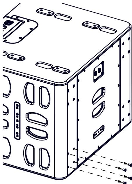
Placer la roulette et fixer la avec les 4 vis crantées fournies.
