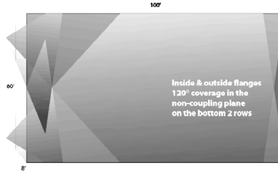
Figure 2 : Vue en plan de la couverture avec deux assemblages GEO verticaux courbés. Les deux profils CDD ont été installés dans les deux enceintes inférieures des clusters.
